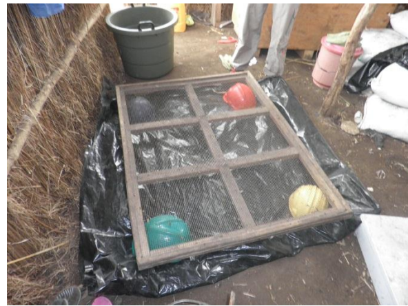
Figure 5 : grille à 10mm (utilisée pour le compost, transformée en table de tri)
